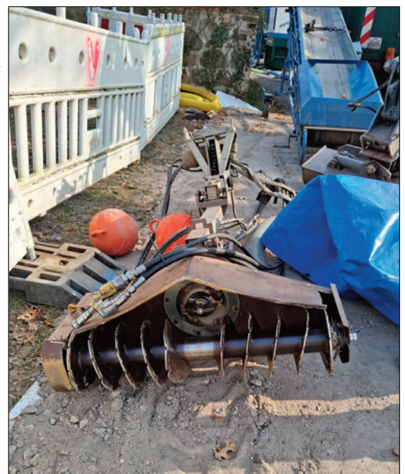
Schaufelrad zur Schlammlösung, das später am Amphibienfahrzeug montiert wird und den Boden des Sees zunächst auflockert, bevor der Schlamm abgepumpt wird,
